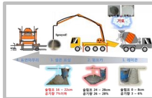
하이브리드 셀룰러 스프레이 콘크리트(강원)
