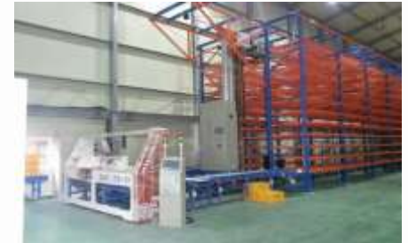
[Mini-Load AS/RS 시스템 시제품]
